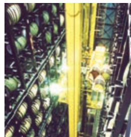
ウイスキー長期貯蔵自動倉庫
